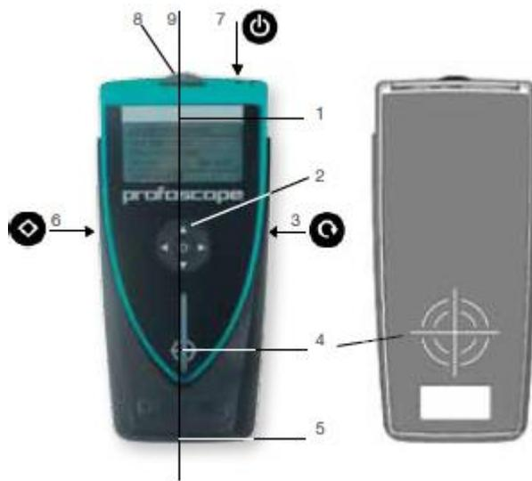
手持式钢筋定位仪旨在实现单手操作。所有功能都可使用两个功能键和导航功能来编程/激活。
