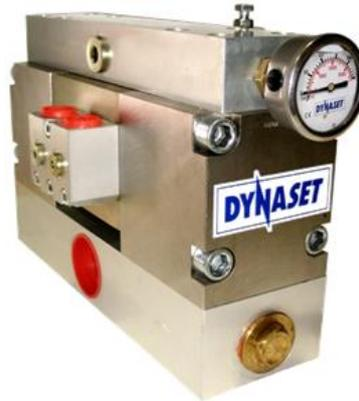
液压直接驱动自吸式柱塞泵，基于液压“自由活塞”技术，免维护设计，具有世界上最大的功率重量比和极长的使用寿命。可无水运行的特性以及良好的进水吸水功能确保了高效的清洗，可轻松从水容器或自然水源泵送出水。
