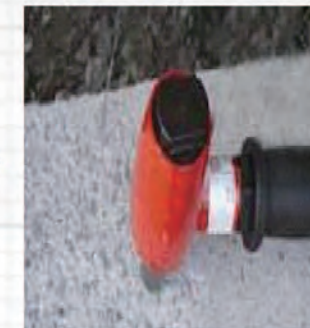
结合处凿毛 基面的凿毛处理要求均匀、轻巧的手持式风动混凝土凿毛器完全适用于立面及顶面的狭小空间凿毛要求。
