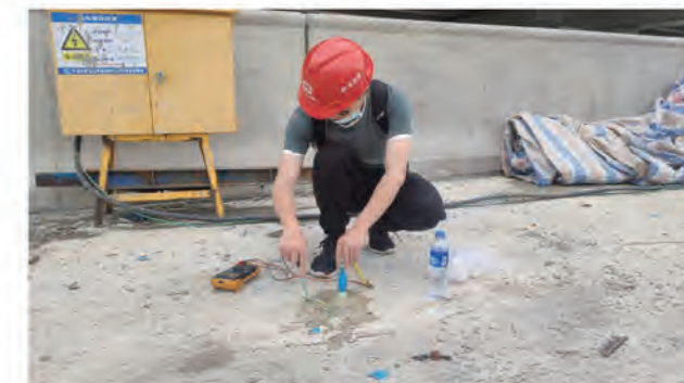
保护电压现场测试图
