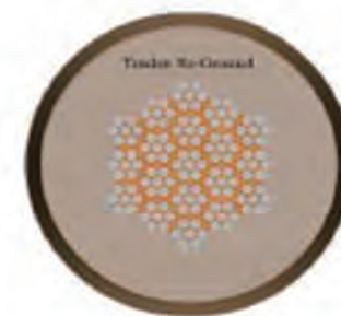
钢绞线表面处理以后,内部腐蚀仍然存在
