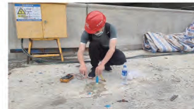
保护电压现场测试图
