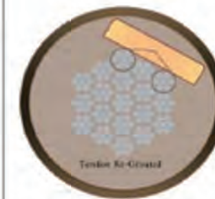
使用抗腐蚀电块后,腐蚀不会产生
